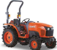
STW40 HST Motorleistung nach ECE-R24: 27,3 kW / 37,1 PS Antrieb: 3-stufiger Hydrostat
