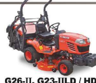
G26-II, G23-IILD / HD HST Motorleistung: G26-II: 19,0 kW / 26,0 PS G23-II: 17,3 kW / 23,5 PS Antrieb: 1 Hydrostat Schnittbreite: G26-II: 1,37 m G23-II: 1,22 m Grasaufnahme mit Hochlenkung
