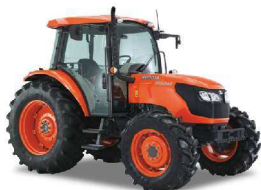
M9540, M8540, M7040 M6040 DTQ Motorleistung nach 97/86/EG: M9540: 65,5 kW / 89,0 PS – 72,9 kW / 99,1 PS Antrieb: 30V / 30R oder M9540 / M8540 / 15V / 15R bei M9040 / M7040
