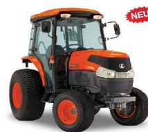
L5740-II, L5240-II, L5040-II, L4240-II Motorleistung nach 97/86/EG: L5740-II: 43,1 kW / 58,9 PS L5240-II: 36,7 kW / 50,9 PS L5040-II: 26,0 kW / 35,8 PS L4240-II: 31,7 kW / 43,1 PS Antrieb: 3-stufiger Hydrostat, 16V / 16R mit Kriechgang DT, 24V / 16R mit Kriechgang Glim-SHIFT
