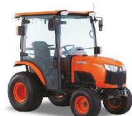
B3150, B2650, B2350 HST / HSTC Motorleistung nach ECE-R24: von 15,2 kW / 20,7 PS bis 20,9 kW / 28,4 PS Antrieb: 3-stufiger Hydrostat
