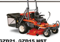
GZD21, GZD15 HST Motorleistung: GZD21: 15,4 kW / 21,0 PS GZD15: 11,2 kW / 15,0 PS Antrieb: 1 Hydrostat, Zero-Turn Schnittbreite: 1,07 m / 1,22 m GZD15: Boden- und Hochlenkung, GZD21: Hochlenkung
