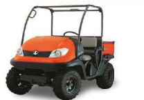
RTV500 Motorleistung: 11,7 kW / 15,9 PS Benzin Antrieb: 2-stufiger Hydrostat / VHT-PLUS
