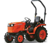
B2420 Motorleistung nach ECE-R24: 15,8 kW / 21,5 PS Antrieb: Schaltgebriebe 9V / 3R
