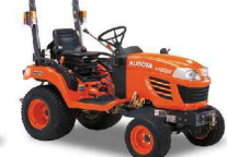
BX2350 HST Motorleistung nach ECE-R24: 15,2 kW / 21,0 PS Antrieb: 2-stufiger Hydrostat
